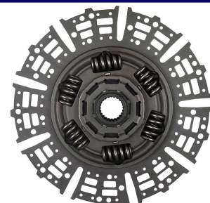
SC 124 SÉRIE 5 / VOLVO 6 MOLAS 24 ESTRIAS PRÉ-AMORTECIMENTO 430MM (SACHS 5453)
